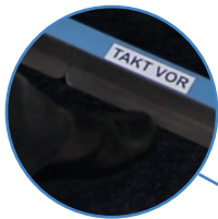
Fußschalter zum Steuern der Einspannelemente
